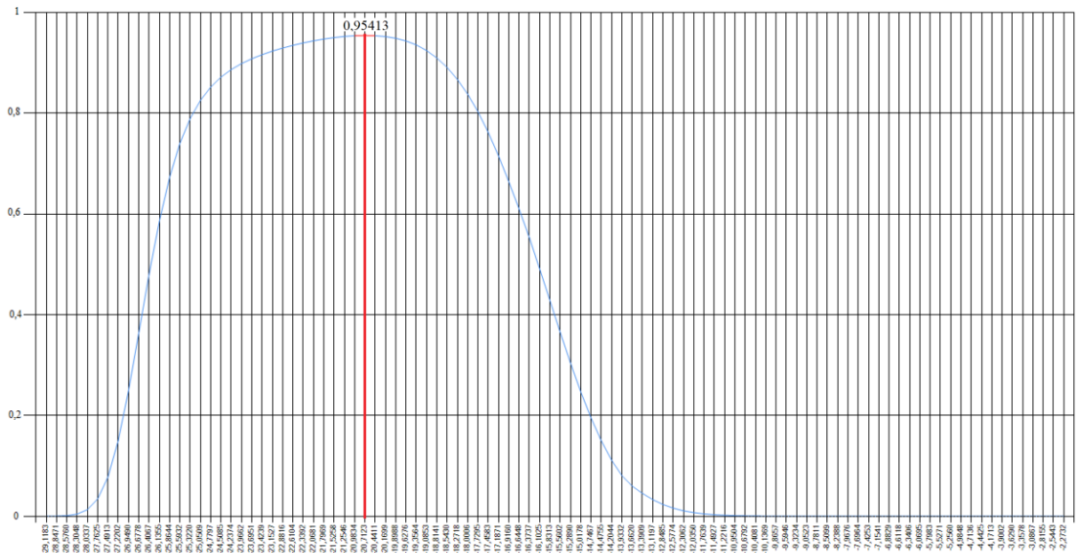
Figura 17. Gráfico do melhor threshold para classificar os corpos d'água usando o filtro Frost 9x9. O Kappa atinge seu valor máximo no valor de threshold -20,71 dB.
