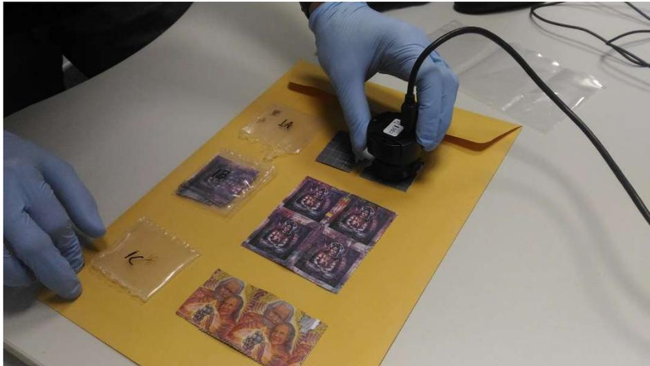
**Figura 5.** Exemplo de aquisição de espectros dos selos com o MicroNIR.
