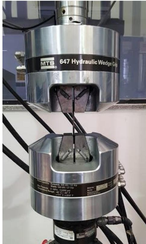
Figura 3.13 – Montagem do CP na MTS 647 Hydraulic Wedge Grip para o ensaio de fadiga.
