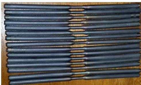
Figura 3.5 - Corpos de prova após o polimento.
