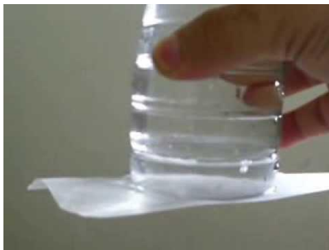
Figura 1. Experimento do copo com água e papel. Evidencia a presença da pressão atmosférica.
