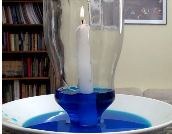
Figura 2. Experimento da vela e a garrafa comprova que o ar ocupa lugar no espaço e a existência da pressão atmosférica.
