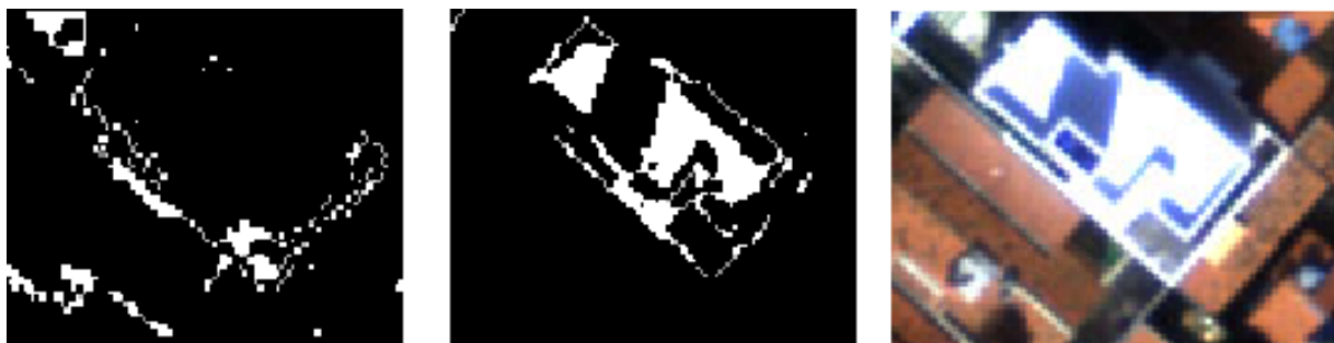
Figura 56 - Detalhe da laje sendo diferenciada do seu contorno.
