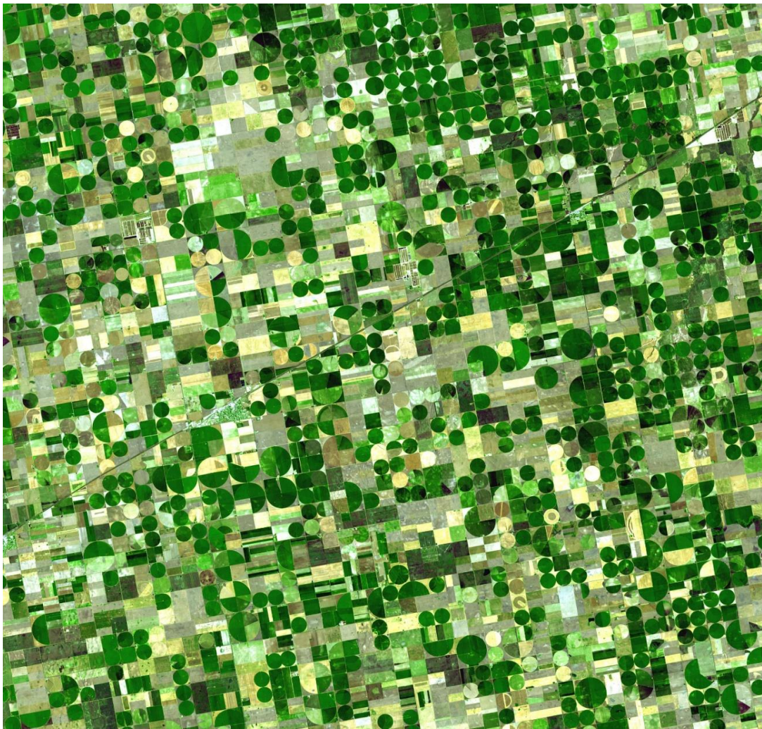
Figura 73 – Imagem RGB do sensor ASTER ( Advanced Spaceborne Thermal Emission and Reflection Radiometer ) de um sistema de irrigação em pivô central, Sublette, Kansas – EUA. Fonte NASA (2016).
