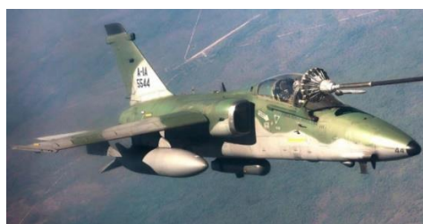
Figura 83 – Aeronave A-1 com sistema Reccelite instalado no cabide ventral. Fonte: Acervo FAB.
