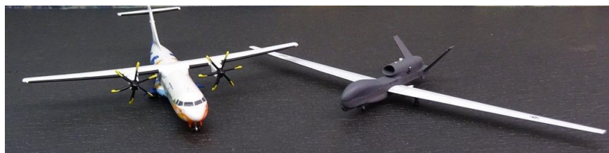
Figura 16 – Comparação entre o tamanho do Global Hawk com 40 m de envergadura e um ATR-72-600, com capacidade para 74 passageiros. Fonte: USAF, 2017.
