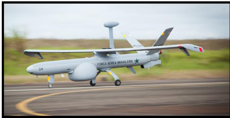
Figura 92 – Hermes 450 com SAR instalado. Fonte: Acervo 1º/12º GAv.
