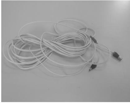
Foto 6 - Cabo para CFTV 4mm com fio flex (10m); 02 Conectores CFTV P-4 com borne; 1 Plug adaptador RCA para BNC macho.
