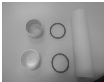
Foto 10 - Luva esgoto Correr 100mm; Tubo 100mm (27cm); Anel de borracha Krona 100mm.
