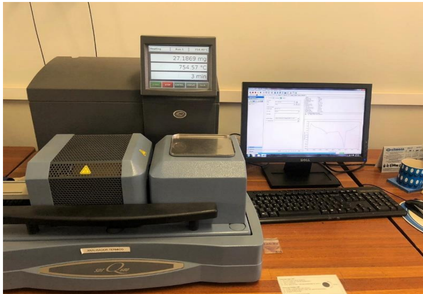
Figura 44 - Equipamento DSC SDT Q600 series utilizado para realização do ensaio de calorimetria exploratória diferencial (Própria, 2019).
