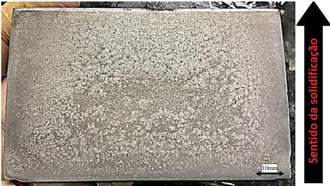
Figura 56 - Macroestruturas da seção longitudinal da liga Al-40%Zn-3%Cu solidificada de forma unidirecional vertical ascendente.
