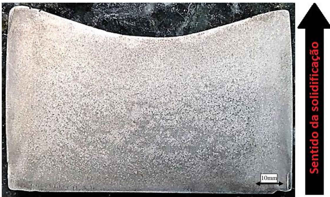
Figura 55 - Macroestrutura da seção longitudinal da liga Al-40%Zn-2%Cu solidificada de forma unidirecional vertical ascendente.
