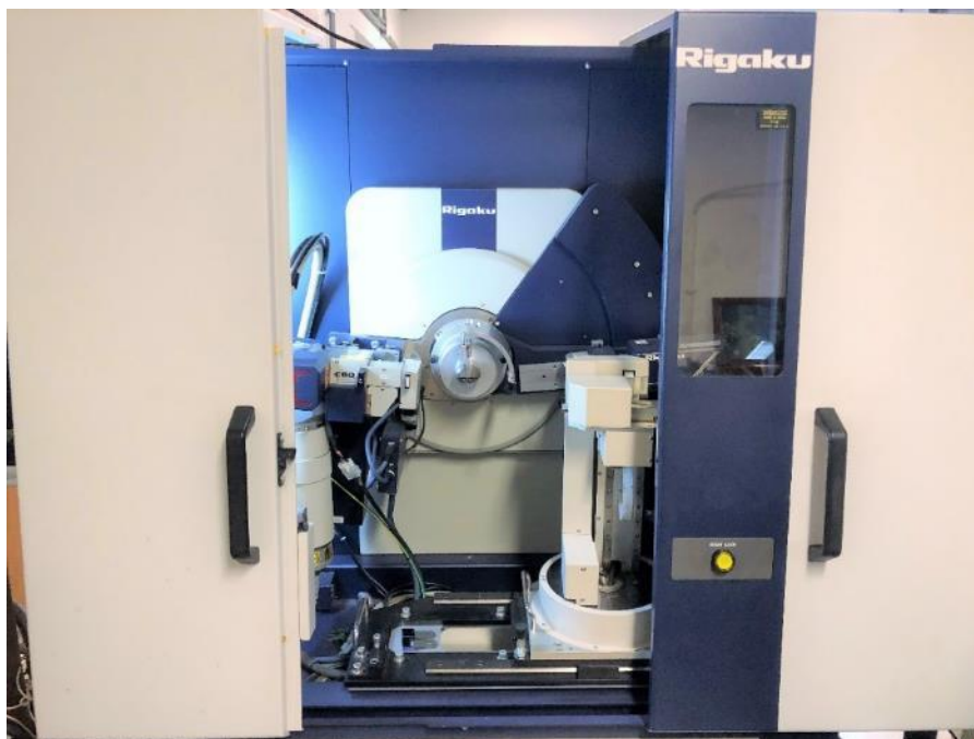
Figura 42 - Equipamento utilizado para realizar o ensaio de difração de raios-x (Própria, 2019).
