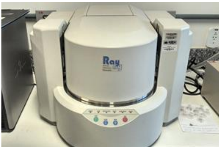
Figura 43 - Espectrômetro de fluorescência de raios-X por energia dispersiva EDX-XDF 720.
