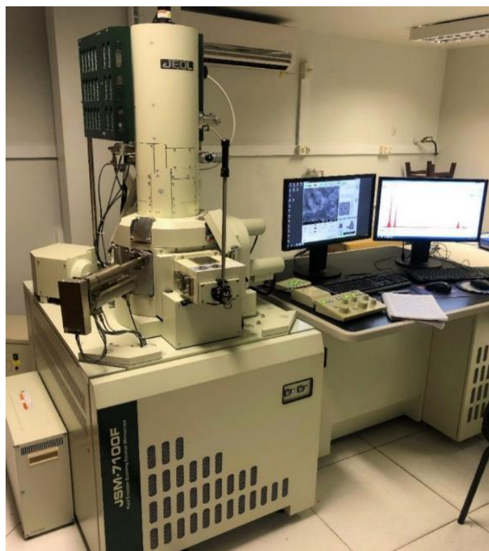
Figura 41 - Microscópio eletrônico de varredura JEOL JSM – 7100F (Própria, 2019).
