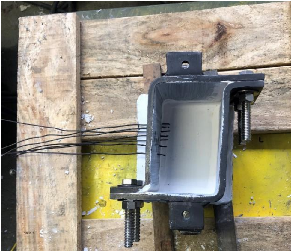
Figura 32 - Lingoteira montada e pronta para realizar um ensaio (Própria, 2019).
