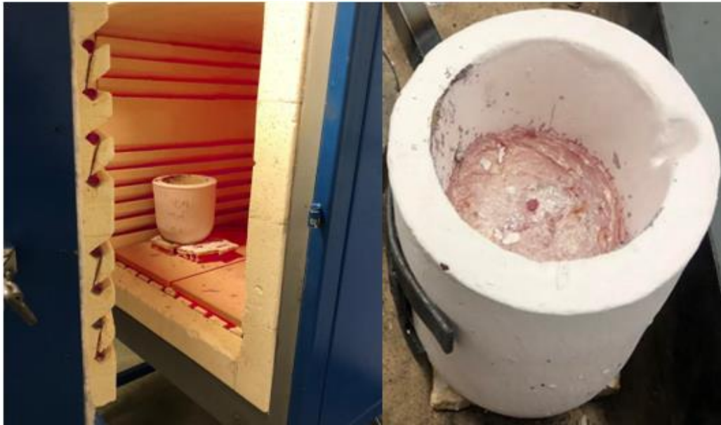
Figura 29 - Forno tipo mufla e cadinho com alumina QF-180 (Própria, 2019).
