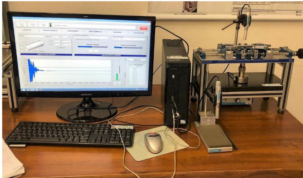
Figura 47 - Equipamento utilizado para realização da técnica de excitação por impulso (Própria, 2019).
