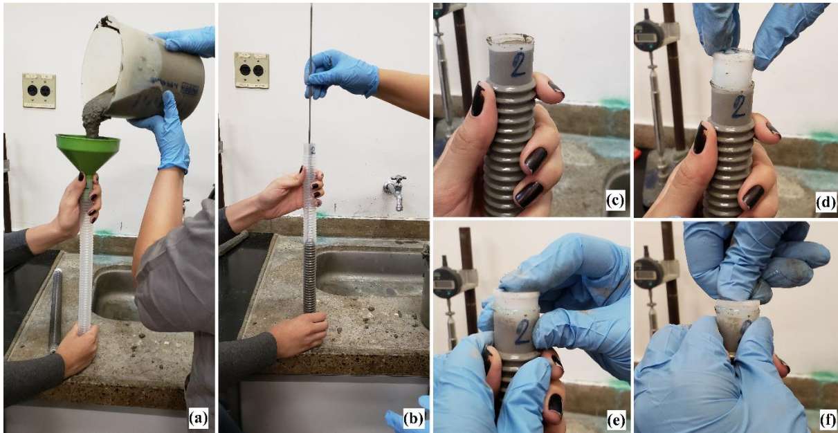
Figura 3.12: Procedimento de ensaio do tubo corrugado. (a) Preenchimento do molde com auxílio de um funil, (b) adensamento da camada com haste metálica, (c) tudo completamente preenchido, (d) tampa com cola epóxi sendo colocada em contato com o material para fechamento do tubo, (e) fechamento do tubo e (f) fixação da tampa superior até secagem da cola.
