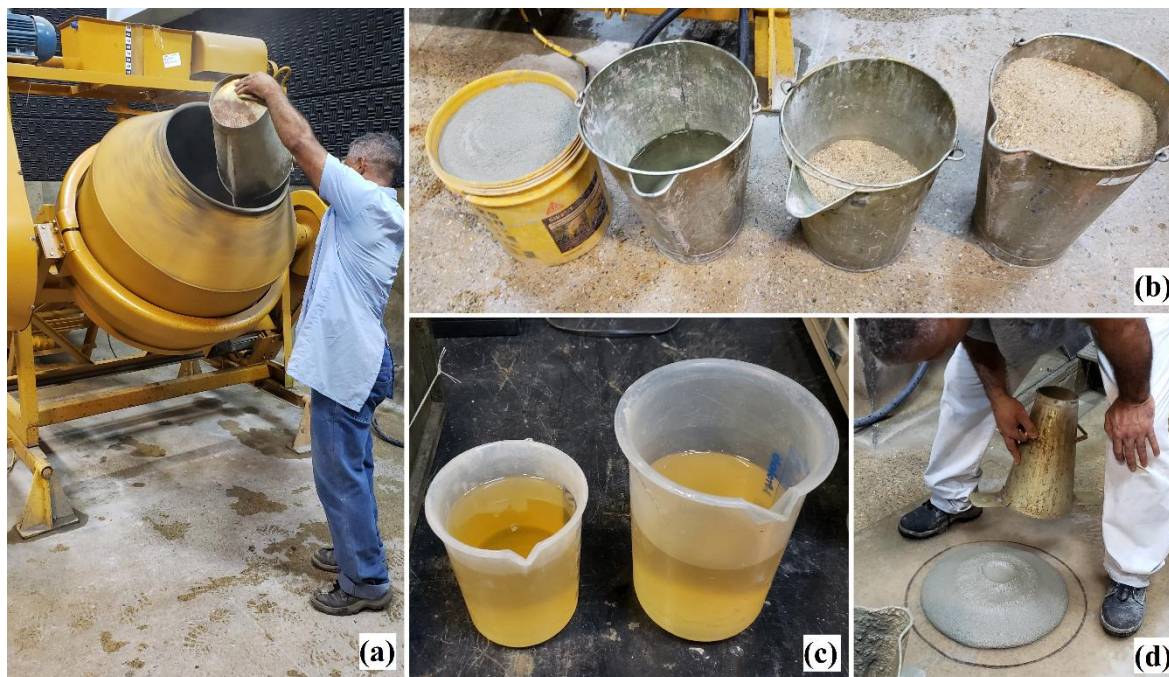
Figura 3.4: Procedimento de produção dos microconcretos. (a) Imprimação da betoneira, (b) materiais secos e água pesados para mistura, (c) superplastificante pesado para mistura e (d) verificação de espalhamento.
