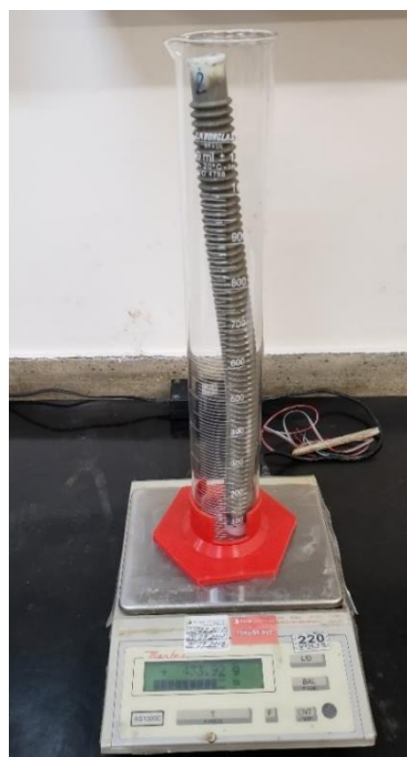
Figura 3.13: Pesagem dos tubos corrugados preenchidos.
