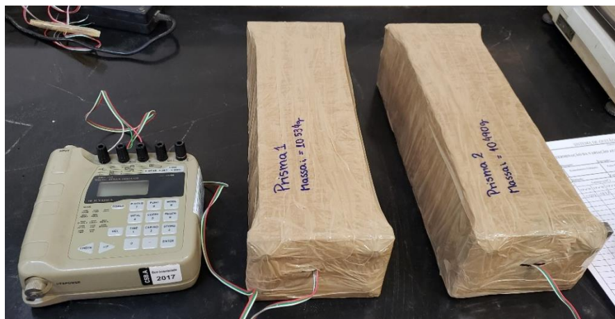
Figura 3.16: Corpos de prova selados e conectados a leitora de dados, em sala com temperatura e umidades controladas.
