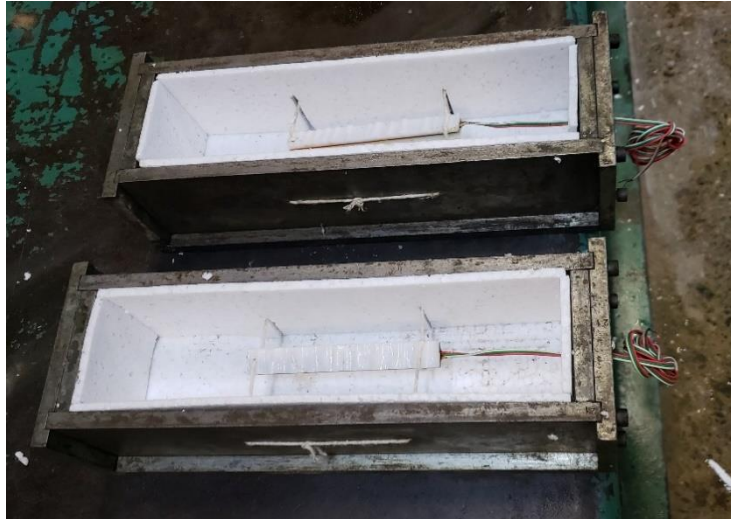
Figura 3.15: Fôrmas revestidas com folhas poliestireno expandido e com os extensômetros já instalados.
