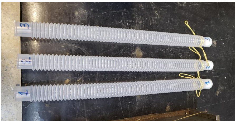
Figura 3.11: Tubos corrugados utilizados para o ensaio de determinação da retração autógena.
