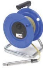
Figura 3.23 Medidor de nível d'água (DNIT, 2015).
