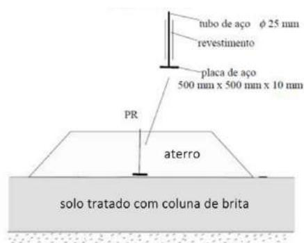
Figura 3.19 - Desenho esquemático de instalação de placa de recalque (DNER, 1998).
