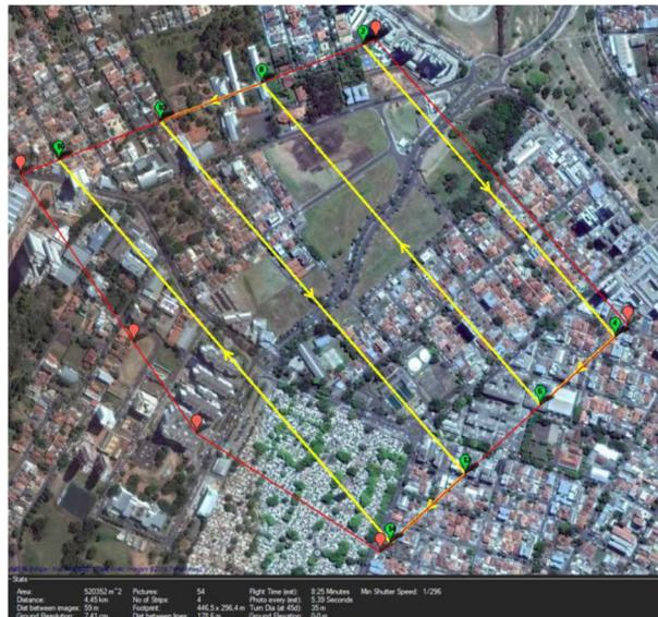
Figura 2.33 - Planejamento de voo do drone asa fixa (DronEng, c2014b).
