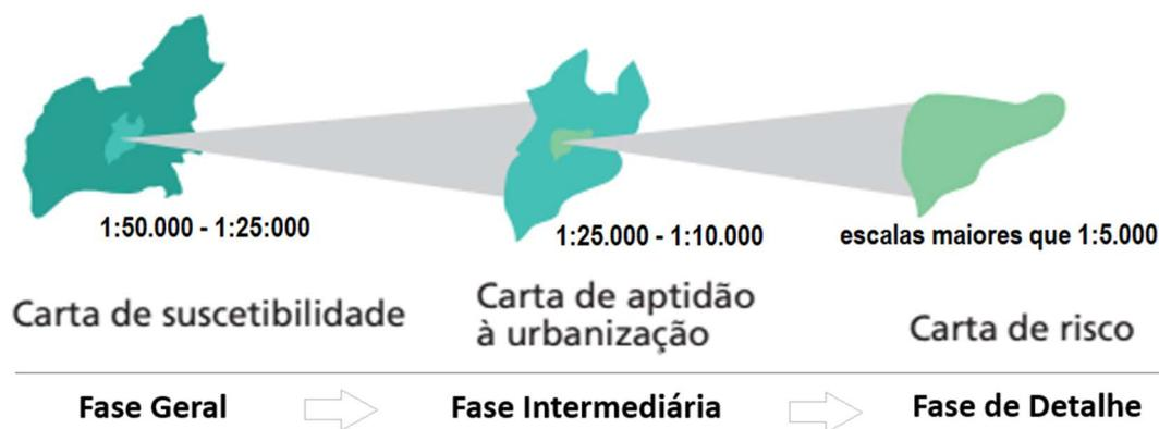
Figura 4.2 - Fases do Detalhamento Progressivo (modificado de Bitar *et al.*, 2015).
