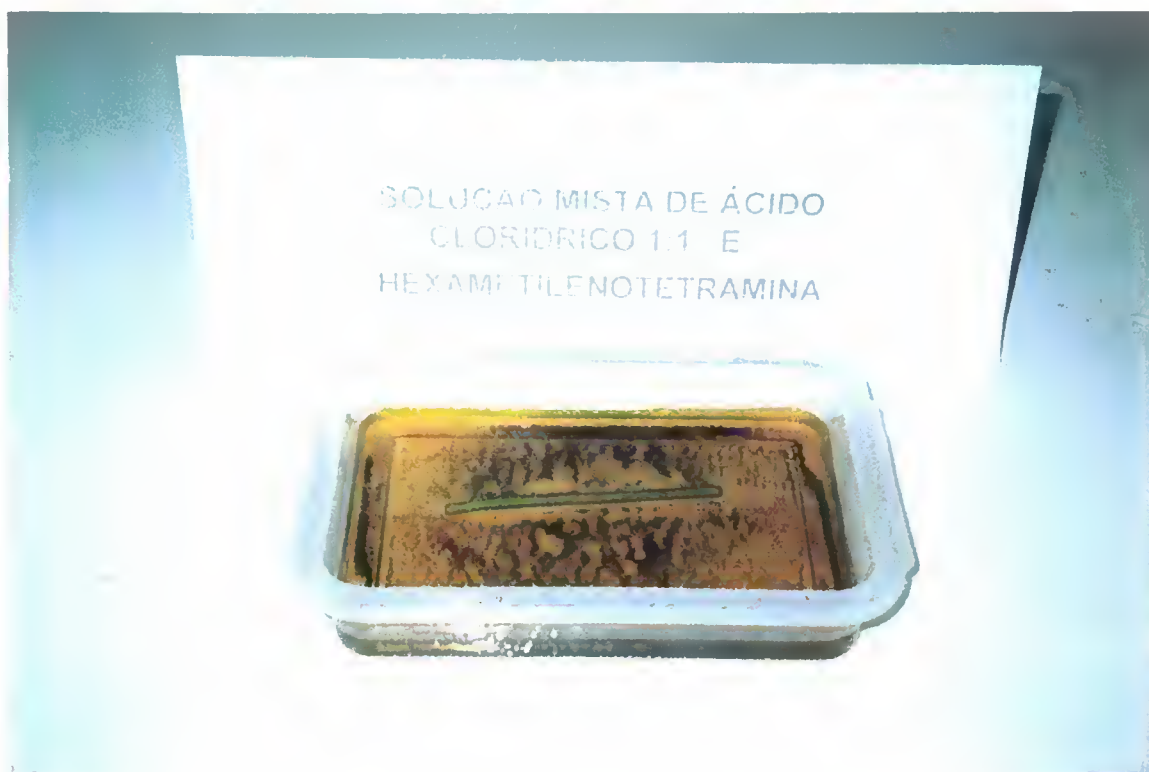
Foto 3.1- Imersão da barra na solução de ácido clorídrico e hexametilenotetramina.
