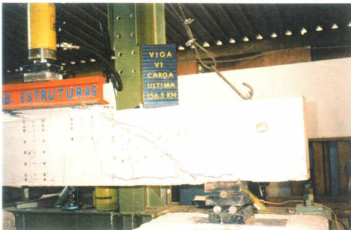
Foto 4.16 - Fissuração da viga V1 para a carga última
