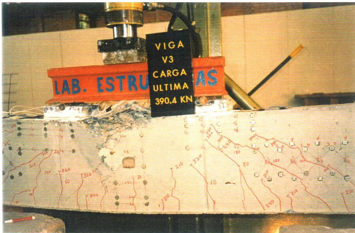
Foto 4.18 - Fissuração da viga V3 para a carga última
