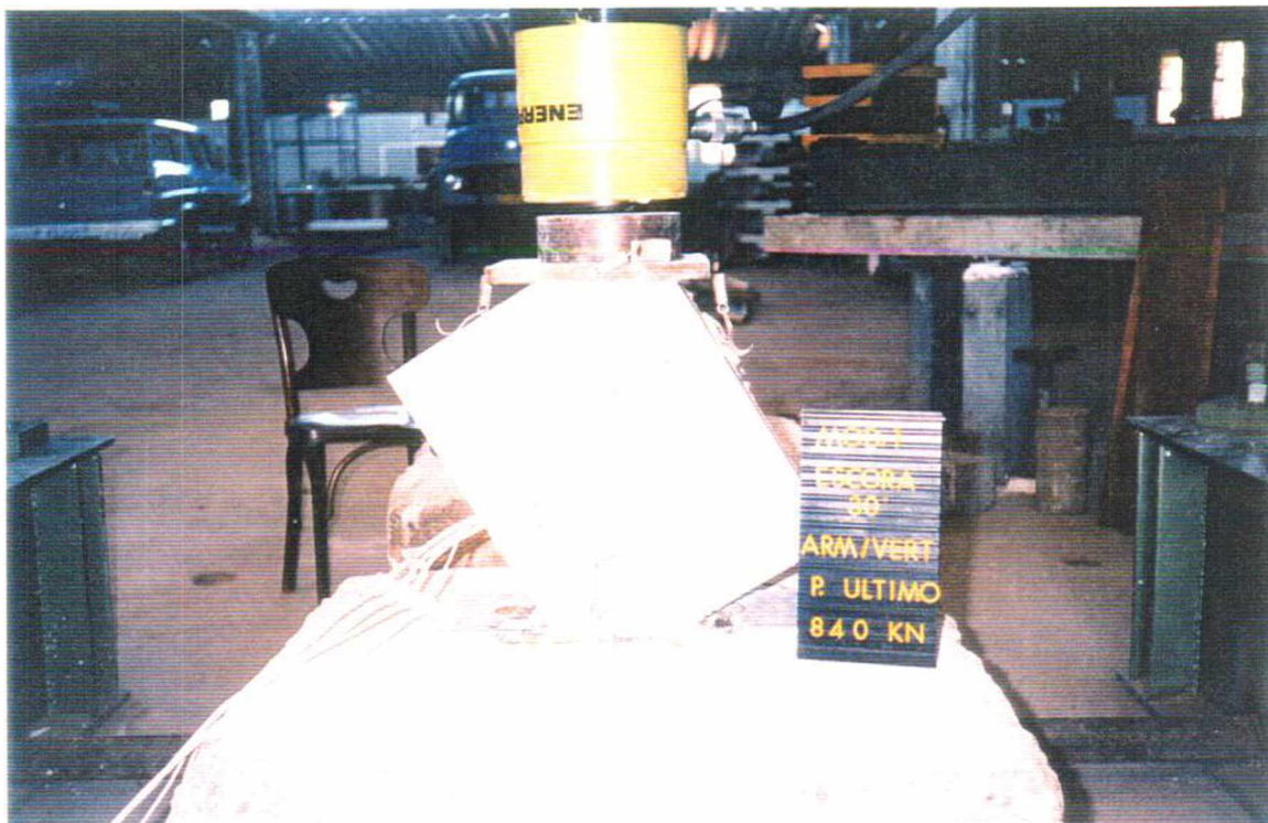
Foto 4.03 - Fissuração do modelo M1-AV para a carga última
