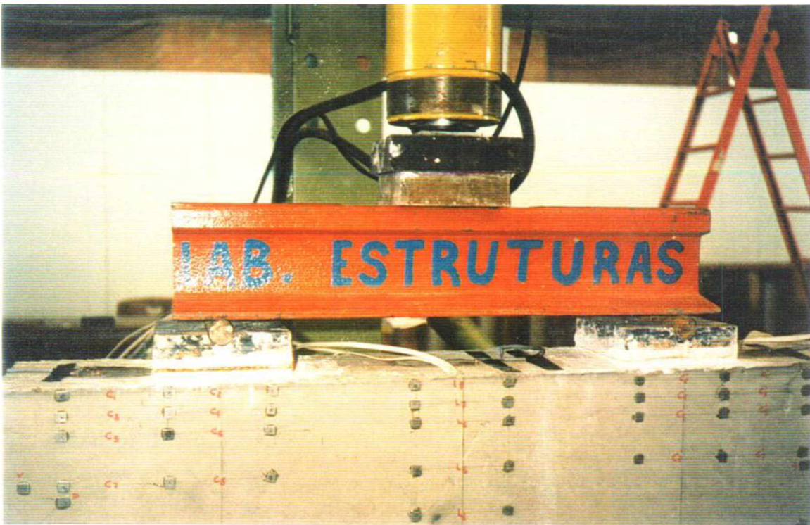
Foto 3.07 - Apoio utilizado para aplicação da carga nas vigas
