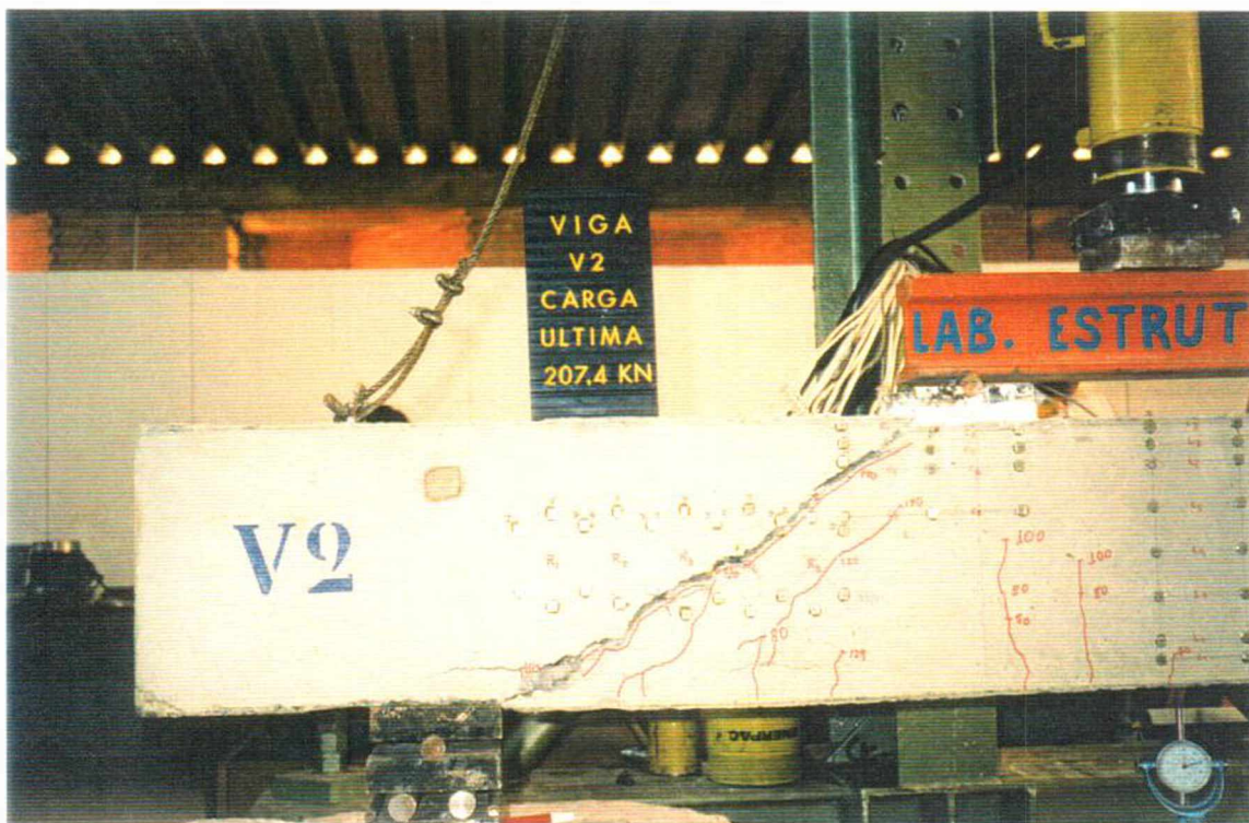
Foto 4.17 - Fissuração da viga V2 para a carga última
