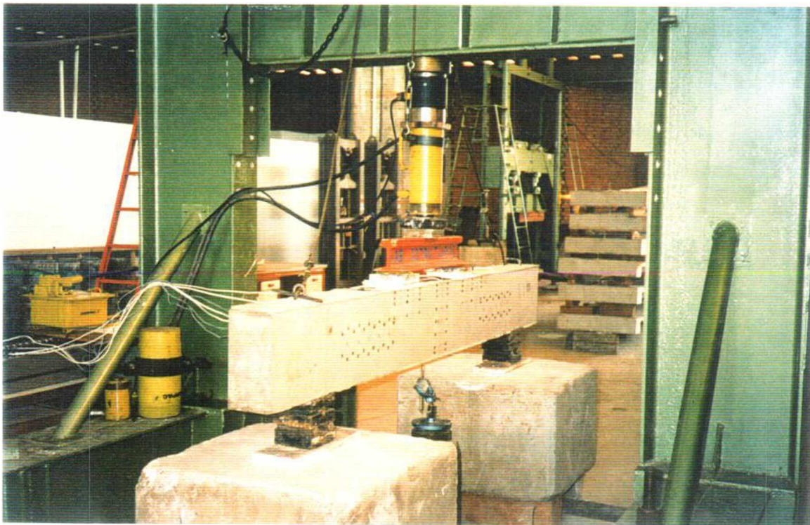
Foto 3.05 – montagem dos ensaios das vigas
