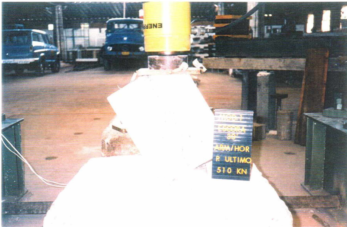
Foto 4.02 - Fissuração do modelo M1-AH para a carga última
