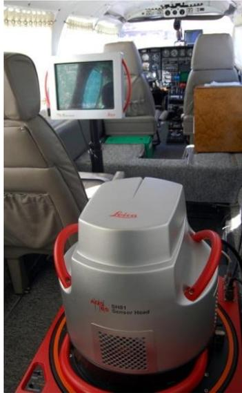
Figura 17 - Sensor ADS-80, da fabricante Suíça Leica Geosystem, utilizado na área de estudo, pela empresa Aeroimagem S/A Engenharia e Aerolevantamento (AEROIMAGEM, 2016).
