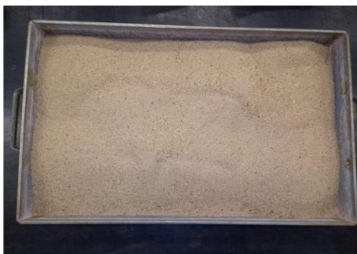
A – Pesagem da quantidade de solo arenoso necessária para o ensaio.
