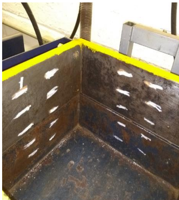
Figura 3.15 – Altura das camadas, feitas com marcações, no interior da caixa de cisalhamento.
