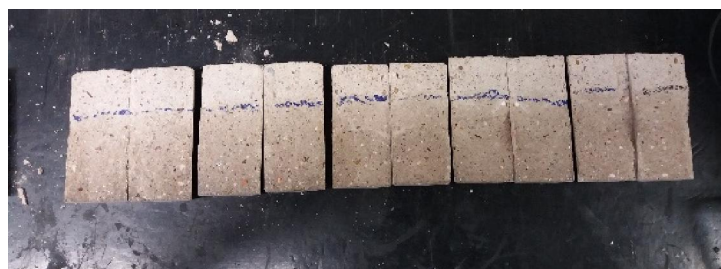
Figura 32 - Ensaio de absorção de água por capilaridade - Corpos de prova rompidos a tração por compressão diametral para visualizar a altura de ascensão capilar.
