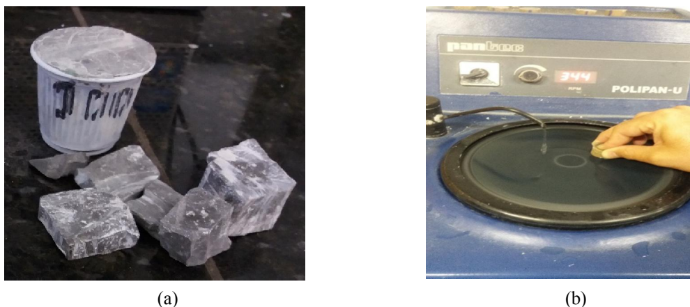
Figura 19- preparação de amostra de pastas: (a) Preparação de amostra de pasta para o ensaio de porosimetria (b) Adequação das amostras no equipamento Politriz
