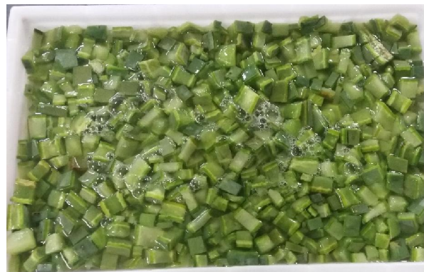
(d) Imersão em água para extração da mucilagem
