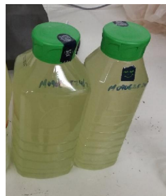
(d) Imersão em água para extração da mucilagem
