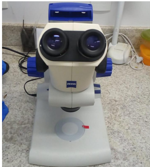
Figura 17. Lupa Zeiss® modelo Stemi 2000 utilizada para a contagem de ovos no teste de toxicidade crônica.
