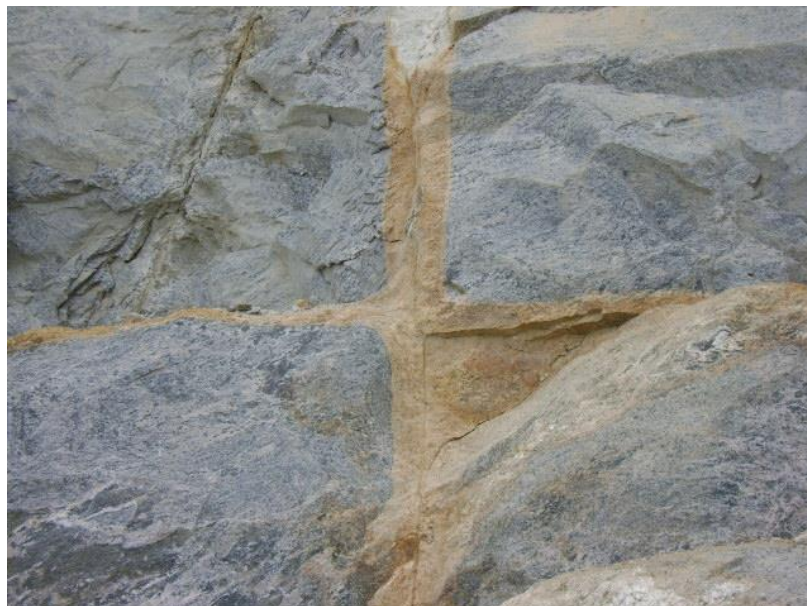
Figura 2-5. Par de fraturamento mostrando alteração ao longo dos planos de aberturas, pelos quais há percolação preferencial de fluidos.
