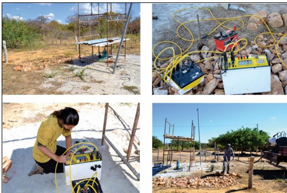
Figura 3-3. Fotografias que evidenciam a aquisição de dados de eletrorresistividade com o equipamento Super Sting e o local do sistema de recarga artificial.
