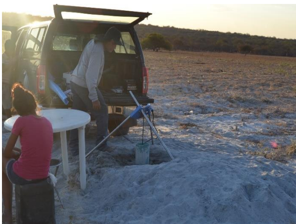
Figura 3-43. Aquisição de dados no Poço Mandacaru 1, é possível observar muita poeira no local devido a perfuração do poço ter ocorrido no mesmo dia da realização da perfilagem.
