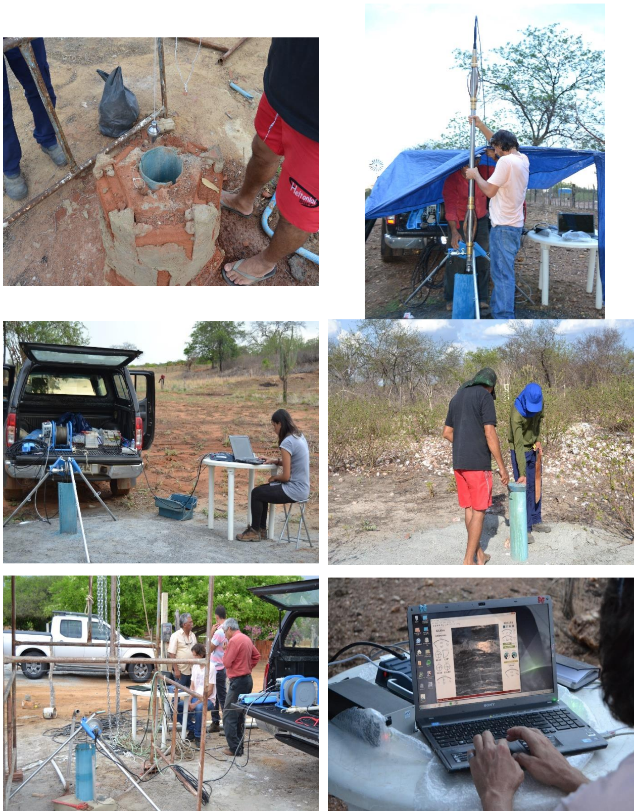
Figura 3-40. Fotos que mostram a aquisição de dados com o perfilador ótico em campo.
