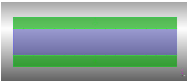
Figura 15. Modelo de caixa de simulação para o sistema amilose, ácidos graxos e MMT-O. As porções em verde serão preenchidas pela MMT-O, já a porção em violeta, pelo restante do sistema.
