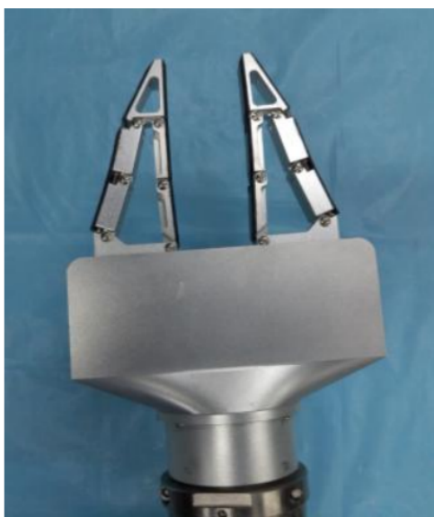
Figura 2.8: Demonstração do mecanismos de uma garra robótica sub-atuada de dois dedos
