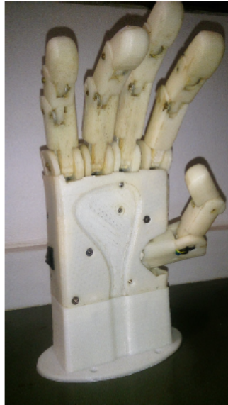
Figura 3.1: Garra robótica antropomórfica desenvolvida por [99]
