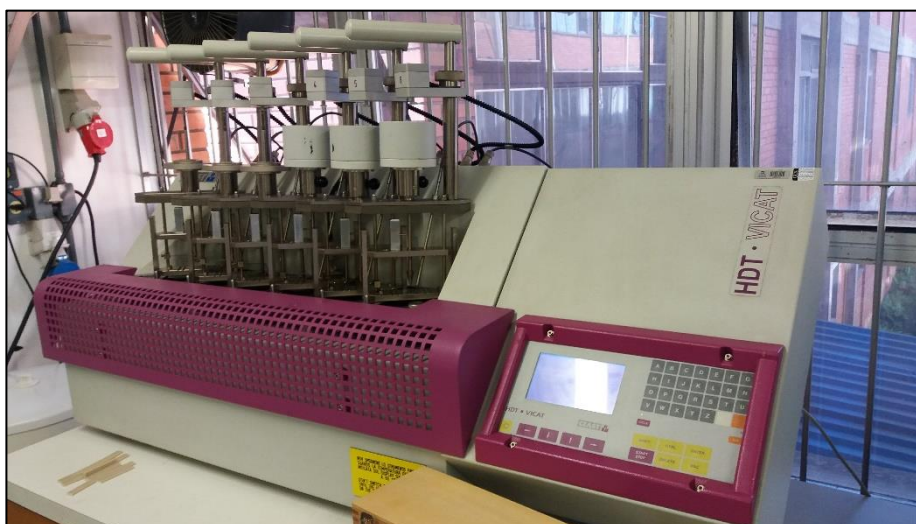
Figura 7. Equipamento CEAST, modelo HDT/6VICAT.
