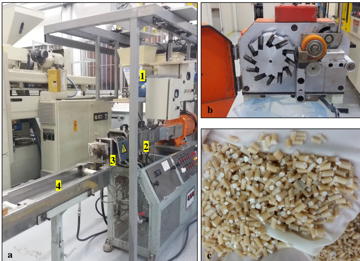
Figura 4. a) Extrusora dupla rosca (1- silo de alimentação, 2-aquecimento e mistura do material, 3- cabeçote de saída do espaguete, 4 – tanque banho frio); b) cortador para obtenção dos “pellets”; c) pellets da mistura (ABS/Fibras).
