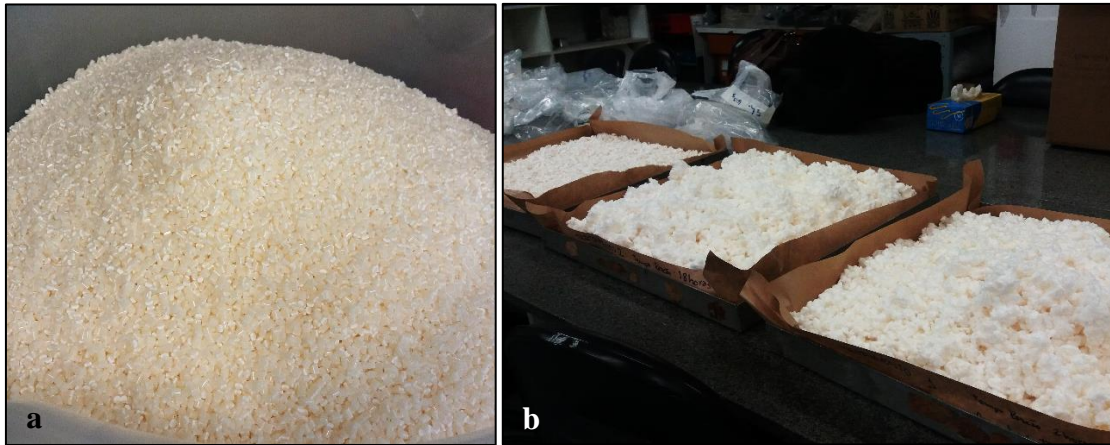
Figura 3. Materiais constituintes dos compósitos. a) ABS (acrilonitrila-butadieno-estireno); b) Fibras de polpa celulose (NT, T1 e T2).
