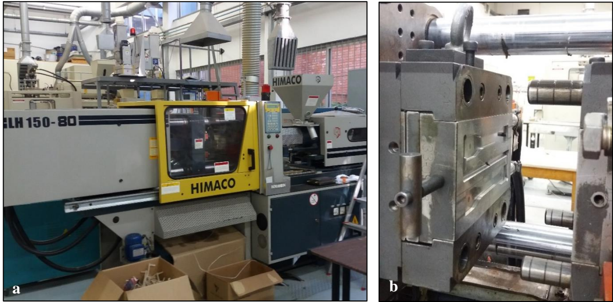
Figura 5. a) injetora para confecção dos corpos de prova; b) molde do corpo de prova de tração encaixado na injetora.
