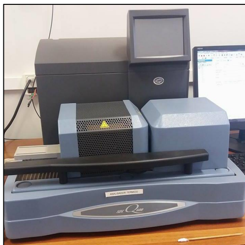
Figura 2. Analisador simultâneo TGA-DSC da TA Instruments, modelo Q600.
