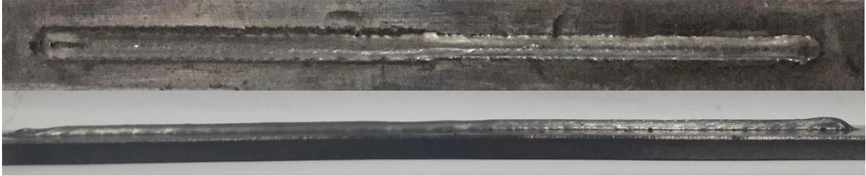
Figura 5.27: Cordão final obtido com o sistema de controle com uma largura de 7 mm e o reforço de 3 mm, e uma largura de 5 mm e o reforço de 3 mm
