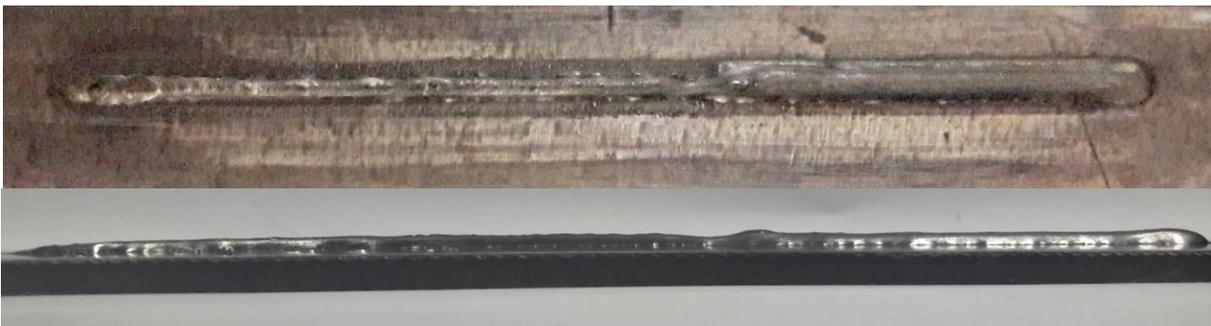
Figura 5.34: Cordão final obtido com o sistema de controle com uma largura de 6 mm e o reforço de 2 mm, e uma largura de 5 mm e o reforço de 2 mm.
