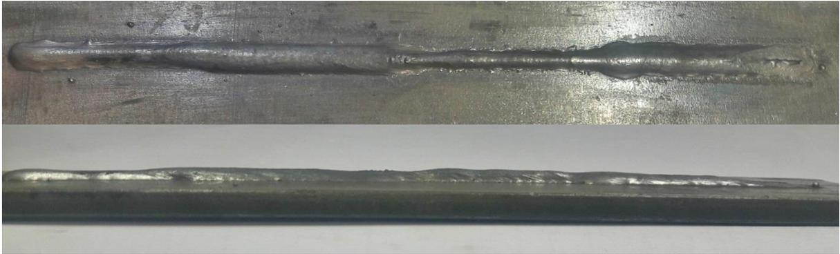
Figura 5.7: Cordão final obtido da parte 3 dos experimentos.
