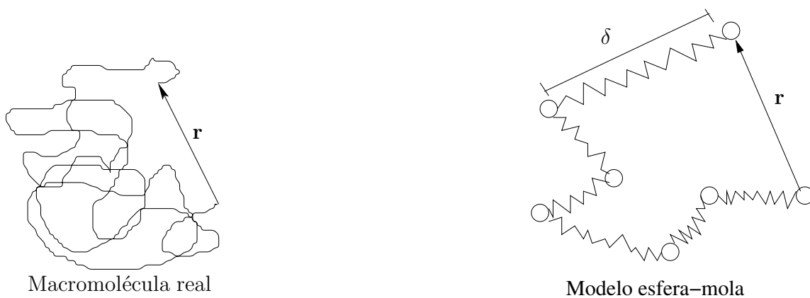
Figura 4.1: Representação esquemática de uma macromolécula no modelo “ dumbbell ”. O vetor \mathbf{r} liga as extremidades da macromolécula de ponta-a-ponta e \delta é o comprimento de um monômero individual, como visto na seção (2.2).
