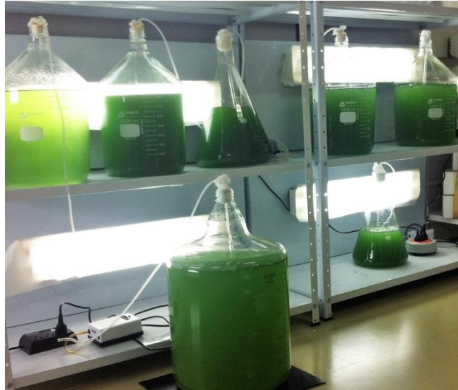
Figura 4.4 – Representação do cultivo de Cylindrospermopsis raciborskii na sala de cultivo do Laboratório de Saneamento Ambiental da UnB.
