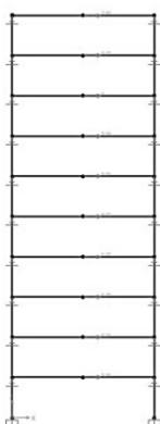
Figura 3.5 – Modelo SF da estrutura experimental.
