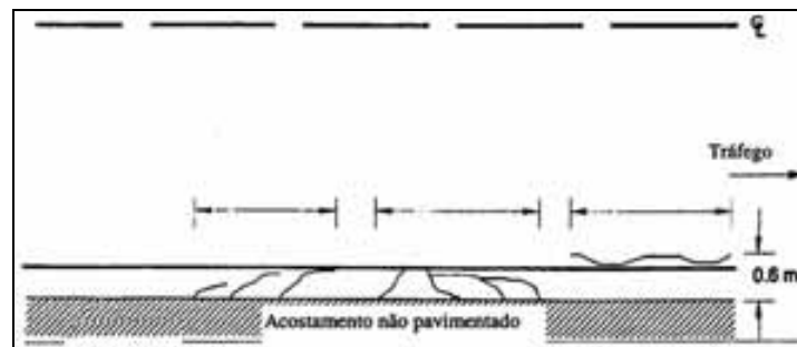
Figura 3.20 – Trincamento na borda (DNER, 1998)
