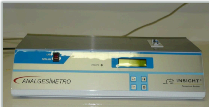
Figura 7: Analgesímetro digital Insight® utilizado no ensaio de Retirada de Cauda. O animal é colocado sobre a placa metálica e tem sua cauda gentilmente alocada sobre um filamento de cobre a ser aquecido.
