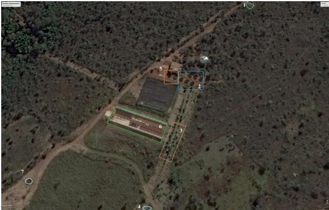
Figura 3. Os sete elementos do sistema aquapônico estudado. 1 – Reservatório de entrada; 2- Seis tanques de peixes; 3- Sistema de filtros biológicos; 4 – Sistema biológico; 5 – Sistema de nutrição vegetal; 6 – Estufas de produção vegetal; 7 – Tanque de recalque da entrada. Fonte: Google Earth Pro, acessado em março de 2018.
