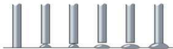
Figura 2. 3: Modo de transferência de metal por curto circuito. Modificado (BOC, 2007).
