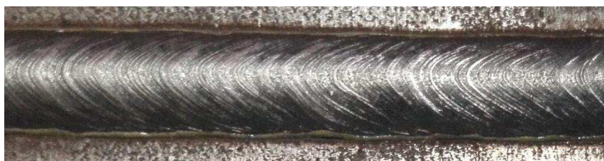
Figura 4. 14: Escamas no cordão de solda.
