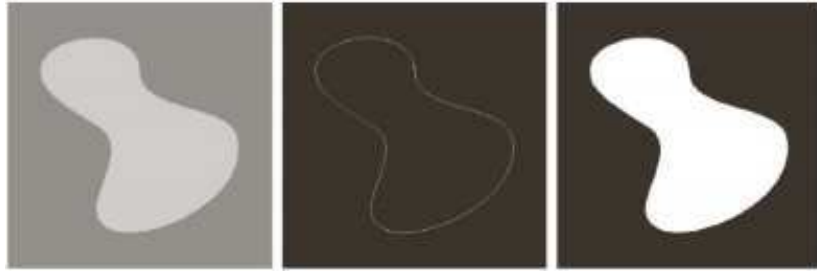
Figura 2. 11: a) Imagem com região de intensidade constante. b) Imagem mostra as bordas da região interior, obtida da descontinuidade de intensidade. c) Resultado da segmentação da imagem em duas regiões. (Modificado de Albuquerque, 2001).
