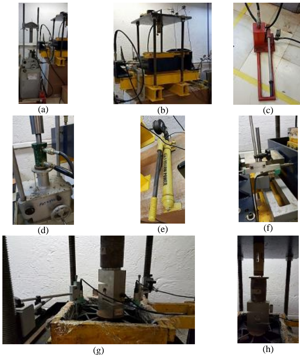
Figura 3.5 Componentes do equipamento do Laboratório de Geotecnia da UnB. (a) conjunto tensão horizontal; (b) conjunto tensão vertical; (c) conjunto Prensa; (d) conjunto tensão normal; (e) conjunto bomba; (f) conjunto carga horizontal; (g) conjunto carga vertical; (h) conjunto tensão normal.
