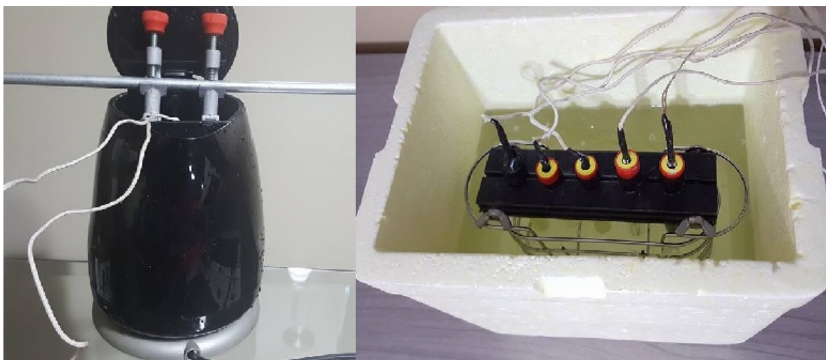
Figura 12 – Reservatórios para os banhos térmicos de água.
