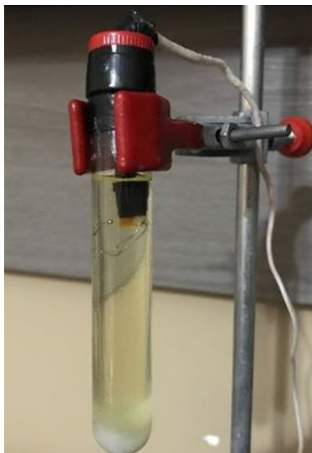
Figura 13 – Posicionamento do termopar dentro do tubo de ensaio.
