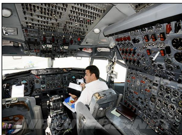
Figura 3. Cabine de comando de uma aeronave da Boeing, modelo 707 (B707), voada na década de 1940.
