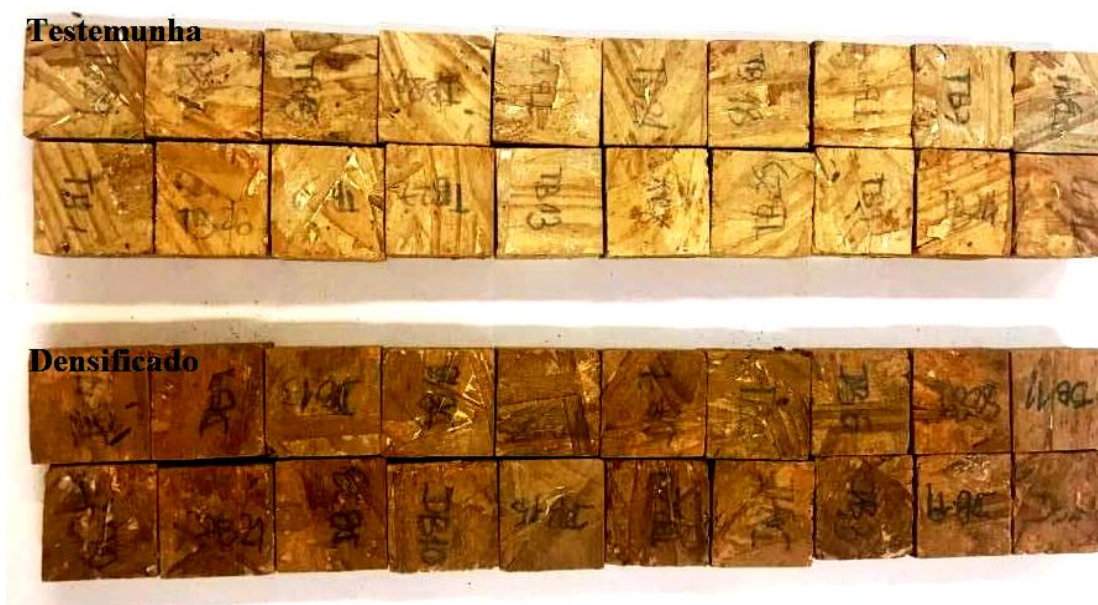
Figura 1. Corpos-de-prova de painel OSB sem tratamento (Testemunha) e com tratamento termomecânico (Densificado) utilizados para o ensaio acelerado de ataque de fungos.
