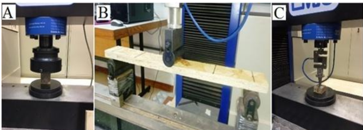
Figura 7. Máquina Universal de Ensaios para ensaios de compressão paralela (A), flexão estática (B) e Dureza Janka (C).
