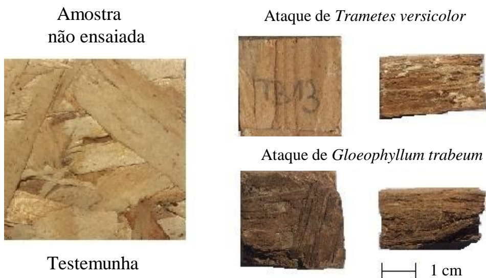
Figura 6. Aspecto visual de painel OSB sem tratamento (Testemunha) antes e após ataque de T. versicolor (Podridão Branca).
