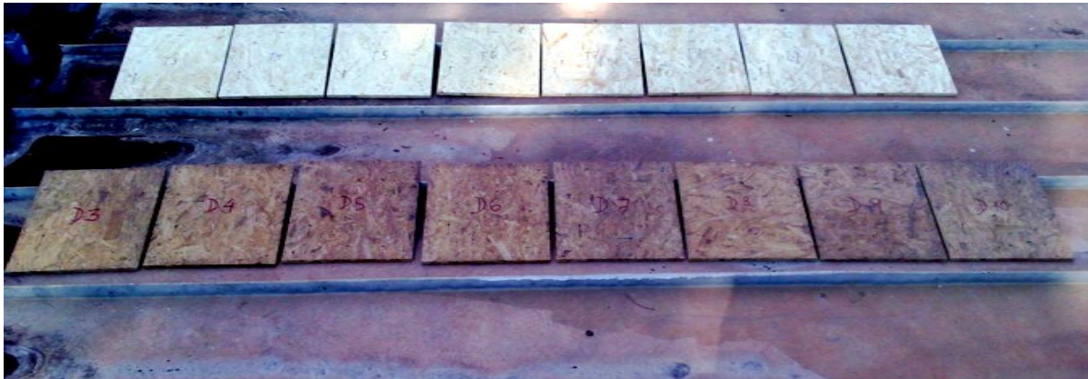
Figura 4. Ensaio de exposição ao intemperismo natural ilustrando os painéis OSB sem tratamento (A) e com tratamento termomecânico (B) na Faculdade de Tecnologia (FT/UnB).
