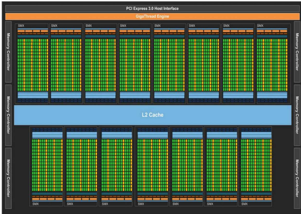
Figura 4.5: Diagrama da arquitetura Kepler com 15 SMs . Alguns modelos da família podem apresentar apenas 13 ou 14 SMs [93].
