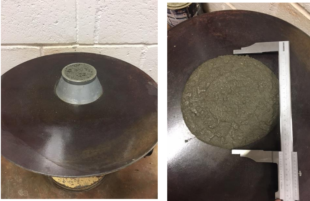
Figura 4-12: Ensaio do índice de consistência. (a) Moldagem do corpo de prova troncônico; (b) espalhamento da argamassa.
