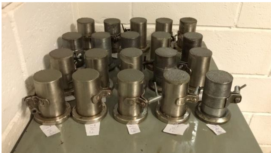
Figura 4-13: Moldagem dos corpos de prova.
