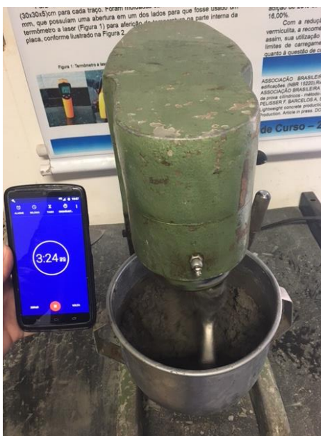
Figura 4-11: Procedimento de mistura da argamassa.
