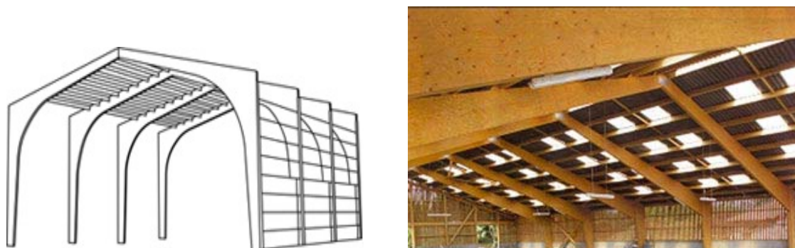
Figura 82 – Exemplos de estruturas em pórticos. Fonte: TIMBERWELD (2006).
