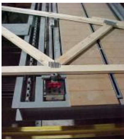
Figura 76 – Treliça pré-fabricada e máquina para produção de componentes com capacidade para 250 a 300 peças por hora. Fonte: WOODTRUSSSYSTEMS (2007).
