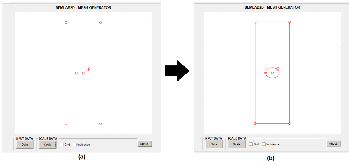
Figura 5.10 - (a) Pontos de referência para desenho dos segmentos; (b) Modelo geométrico finalizado no BemLab2D da chapa com furo central
