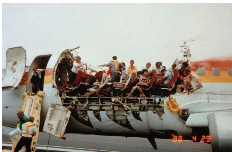
Figura 3.1 - Boeing 737 sem o teto após uma falha provocada por corrosão-fadiga. (Fonte: http://inspecaoequipto.blogspot.com.br/2014/02/caso-060-avioes-comet-falhas-por-fadiga.html )
