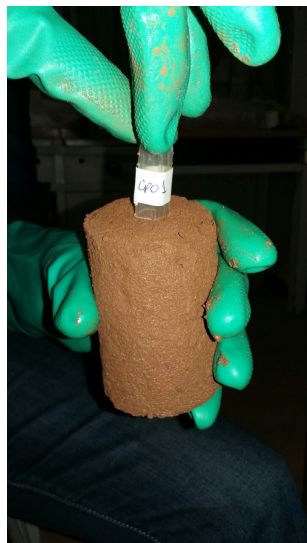
Figura 3.10: Coleta de amostras para microtomografia.
