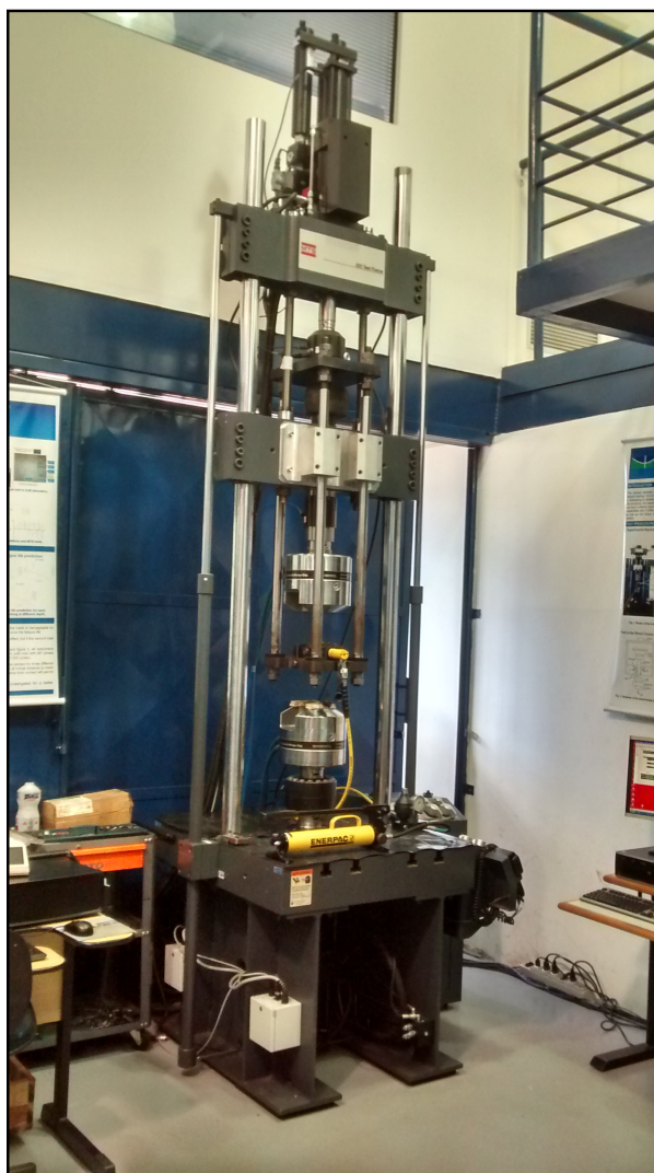
Figura 4.5: Máquina MTS de fadiga por fretting com dois atuadores.
