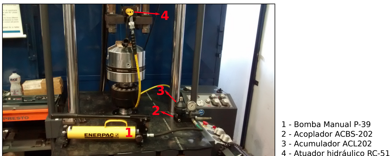
Figura 4.7: Sistema hidráulico manual Enerpac anexado à máquina de fadiga por fretting .
