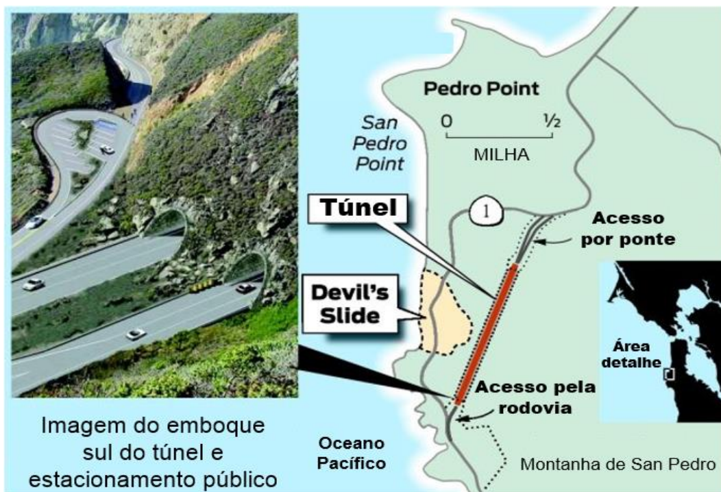
Figura 2.4 – Foto dos emboques e mapa geral do túnel by-pass em Devil's Slide (modificado de Wagner, 2016)
