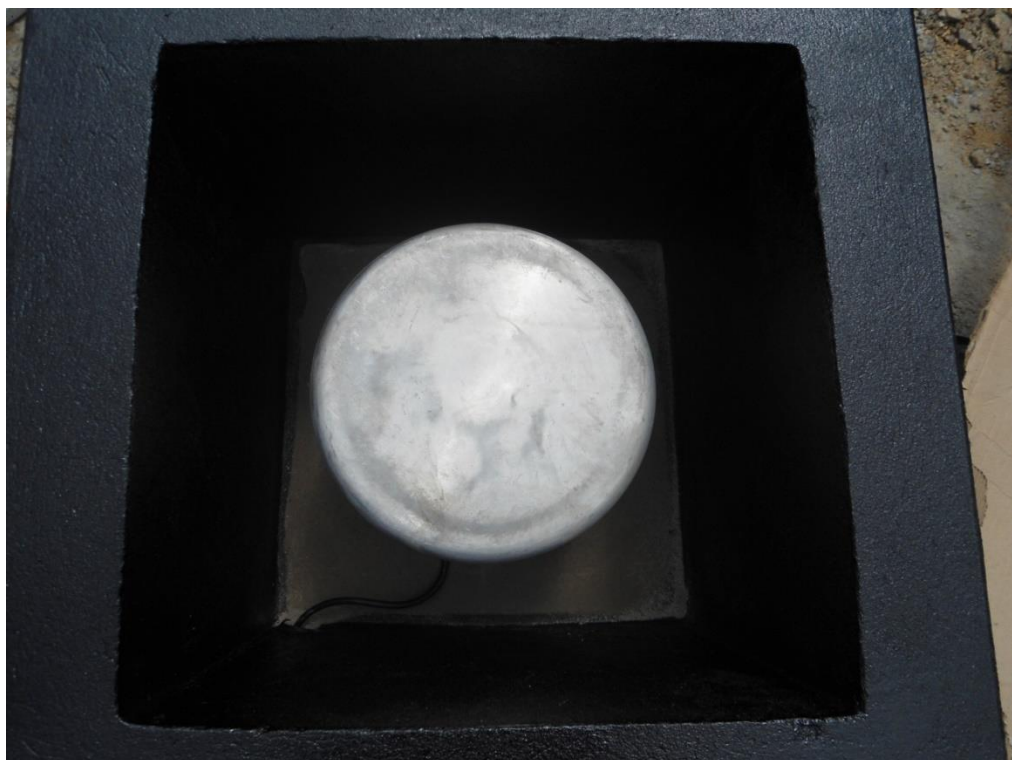
Figura B.5: Proteção auxiliar para o sismômetro.
