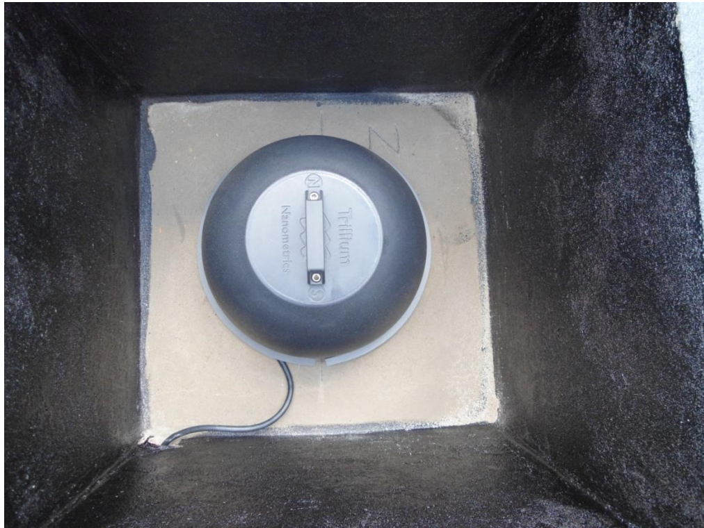
Figura B.4: Sismômetro revestido com uma capa protetora.
