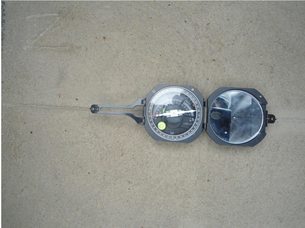
Figura B.2: Base de concreto para instalação do sensor e orientação utilizando uma bússola.
