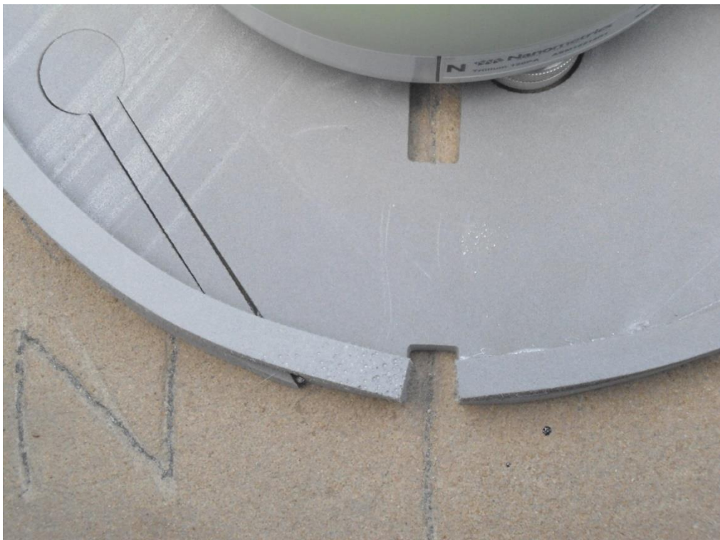
Figura B.3: Sensor Trillium 120PA instalado e orientado para o norte verdadeiro.
