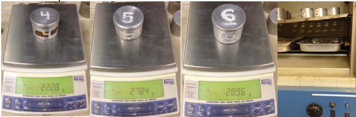
Massas das cápsulas com solo úmido
