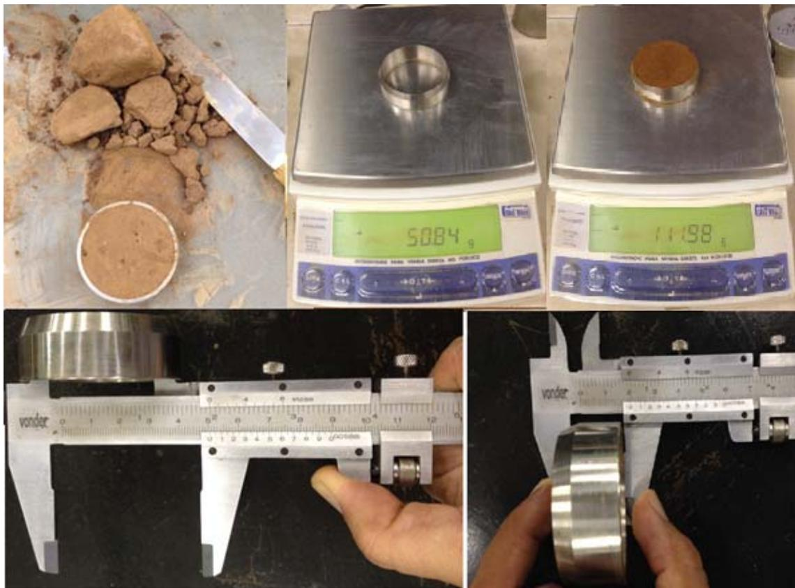
Figura 4.14: Obtenção do índice de vazios por moldagem de amostra
