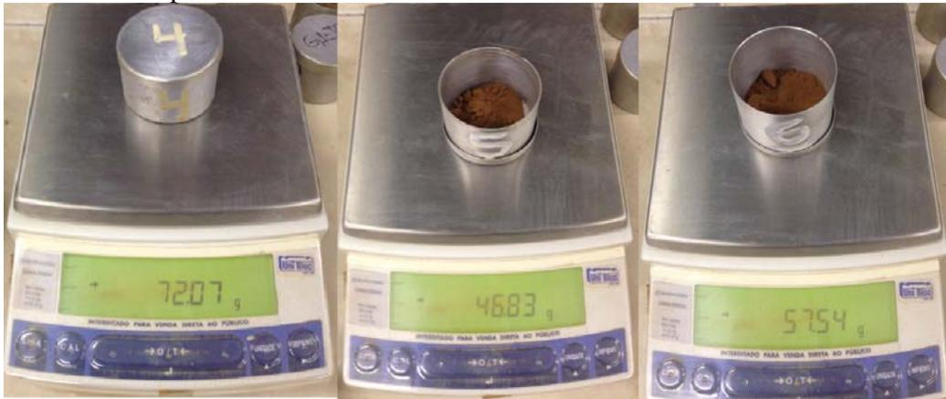
Massas das cápsulas com solo seco
