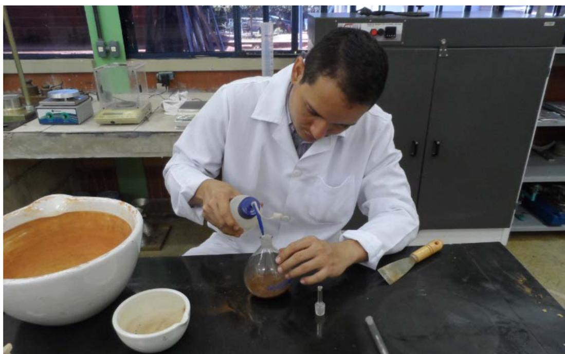
Figura 4.12: Execução de ensaio densidade real dos sólidos pelo Picnômetro.
