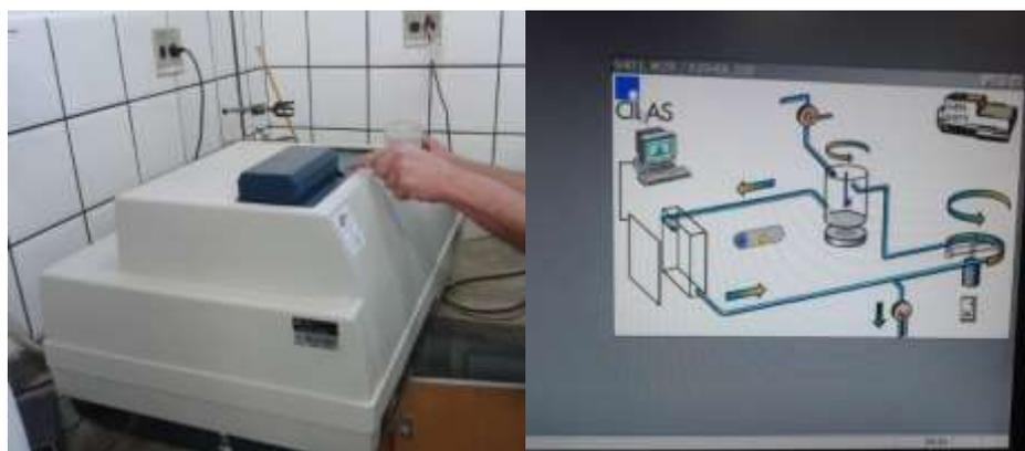
Figura 3. 3 - Granulômetro a laser a ser utilizado na pesquisa.
