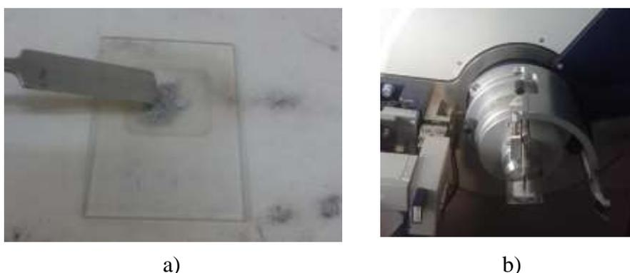
Figura 3. 14 - a) Preparação da lâmina com a amostra em pó; b) realização do ensaio de difração de raio X.
