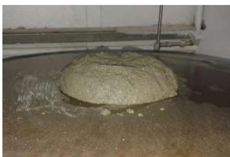
Figura 4. 13 - Ensaio na mesa de consistência.
