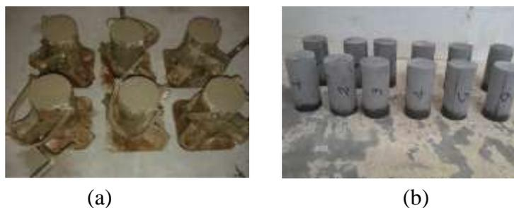
Figura 3. 6 - a) Corpos de prova após a moldagem; b) e após serem desmoldados, pesados.
