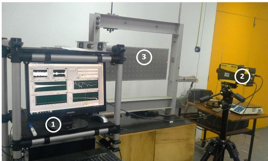
Figura 3.1. Configuração de ensaio modal com (1) Aquisição de dados Labview, (2) vibrômetro LDV Polytec 100, e (3) Painel honeycomb pendurado por fios de nylon.
