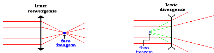
Ilustração 9: Raios de luz ao passar por lente convergente (esquerda) - raios de luz ao passar por lente divergente (direita) Fonte: Colégio São Francisco, 2006.
