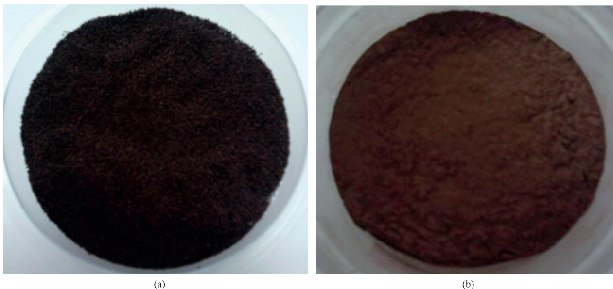
Figura 1. Micrografia do copolímero de estireno/divinilbenzeno. a) resíduo industrial; b) material microparticulado com tamanho médio de 25 µm após cominuição.
