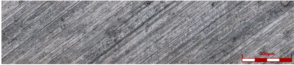
Figura 5.54 Imagem ampliada x20 para a medição de rugosidade Ra, Rz e Rq do corpo de prova com acabamento fresamento.
