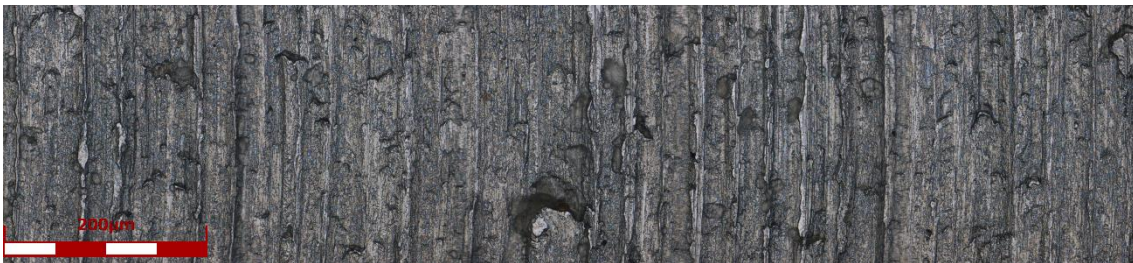
Figura 5.91 Imagem ampliada x20 para a medição de rugosidade Ra, Rz e Rq do corpo de prova com acabamento torneamento.
