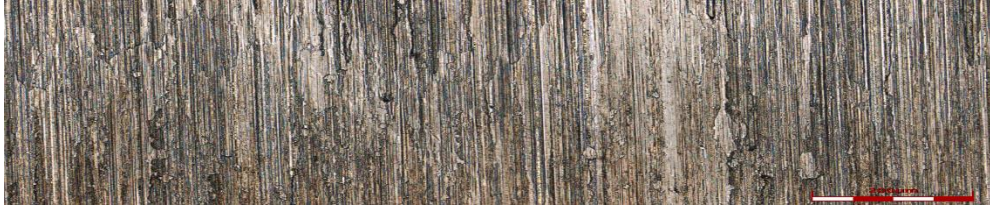
Figura 5.77 Imagem ampliada x20 para a medição de rugosidade Ra, Rz e Rq do corpo de prova com acabamento retificação.
