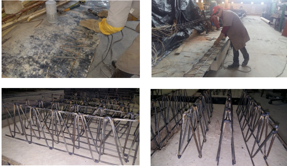
Figura 3.14 – Fabricação de treliças no laboratório de estruturas da UnB
