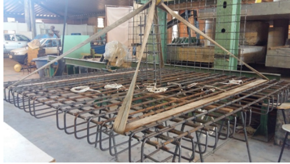
Figura 3.7 – Armadura de flexão laje RSP-A01
