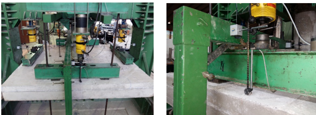
Figura 3.20 – Posicionamento dos LVDT's na superfície superior das lajes
