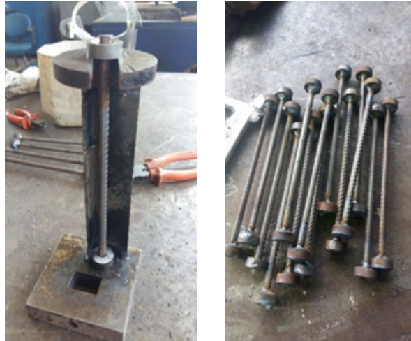
Figura 3.12 – Armadura de cisalhamento ( studs )
