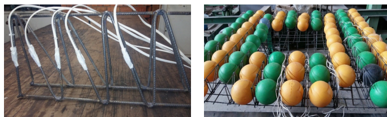
Figura 3.27 – Armaduras de cisalhamento instrumentadas
