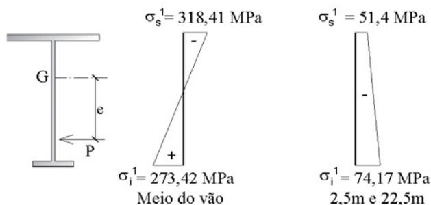
Figura 7.77 – Diagrama de tensões na seção do meio do vão, a 2,5m e 22,5m, no ato da protensão (Exemplo 2)
