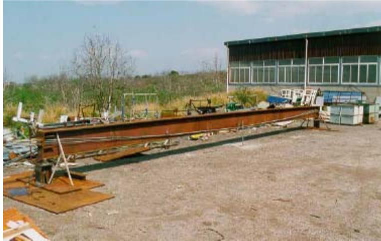
Figura 2.1 - Teste experimental para viga de aço protendida (Nunziata, 1999)
