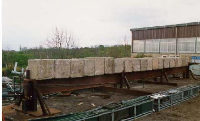
Figura 2.3 - Viga protendida carregada por blocos de cimento (Nunziata, 1999b)
