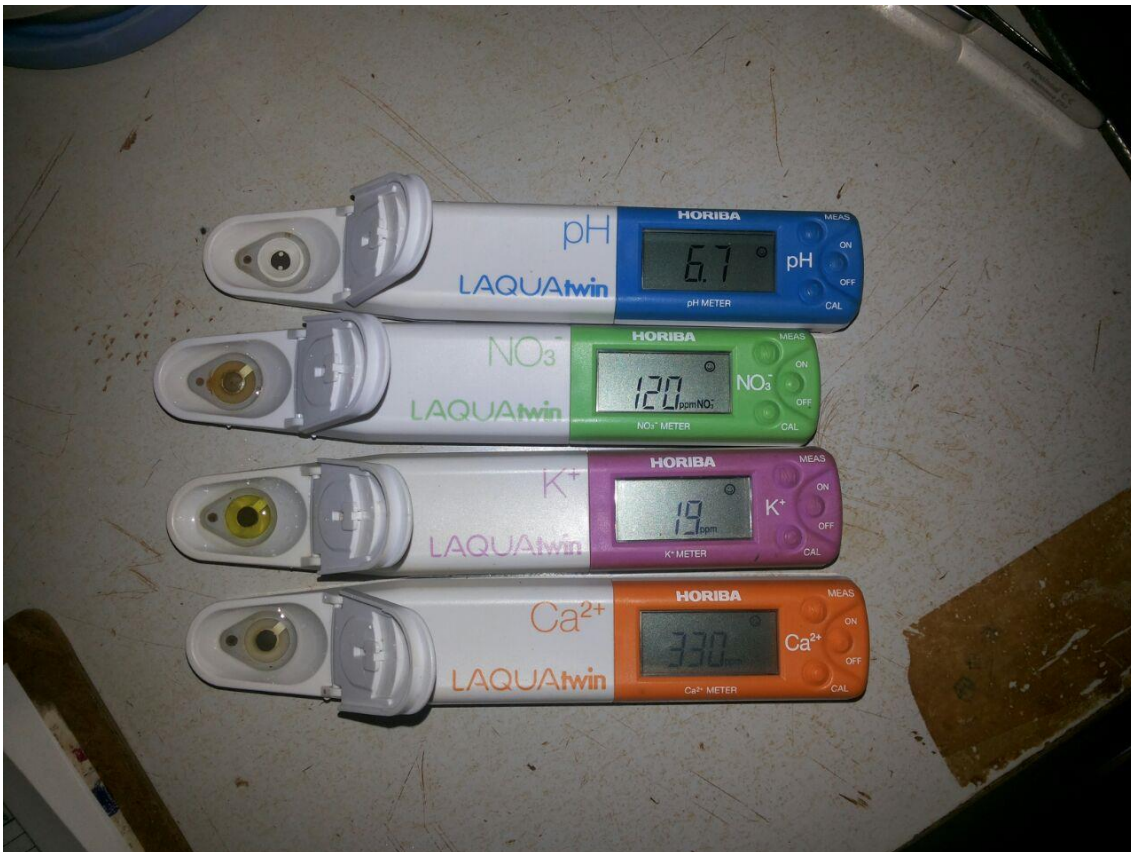
Figura 24: Aparelhos utilizados para medição de íons na solução do solo.
