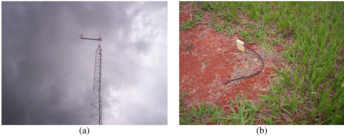
Figura 4.2 – Estação meteorológica: (a) sensor de velocidade e direção do vento; e (b) sensor de umidade do solo. Abaixo da terra encontram-se 3 sensores de temperatura do solo, à 5, 10 e 20 cm.
