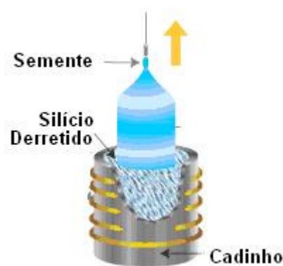
Figura 2.25 – Crescimento do silício monocristalino utilizando a técnica Czochralski. (fonte: DOE – EERE, 2005, modificado)
