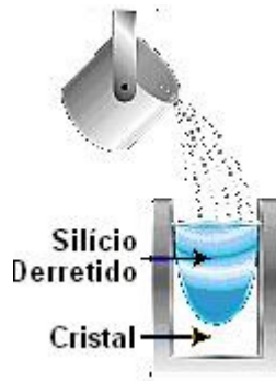
Figura 2.26 – Processo de fabricação do silício policristalino. (fonte: DOE – EERE, 2005, modificado)
